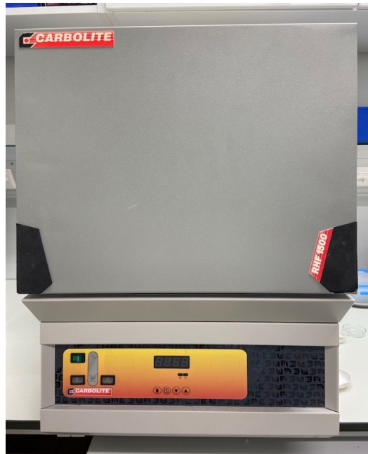
Abb. 5. Sinterofen CARBOLITE RHF 1500.
