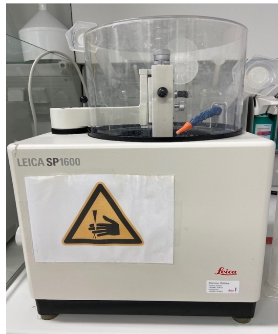
Abb. 4. LEICA SP 1600 Innenlochsäge.
