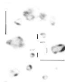
Abb.5.3: Inverse Streulichtmikroskopieaufnahme eines Pulvers. Die kurzen Striche entsprechen 2 mm, die langen 10 mm.
