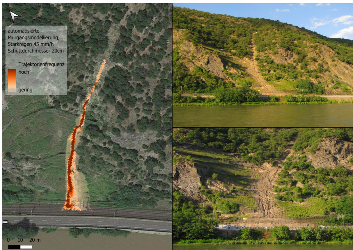
Abb. 108: Vergleich zwischen der automatisierten Murgangmodellierung und Fotoaufnahmen kurz nach einem Ereignis in der Tiefenlinie bei Dörschied im Oberen Mittelrheintal (Fotos: B. Bock 07.07.2012)
