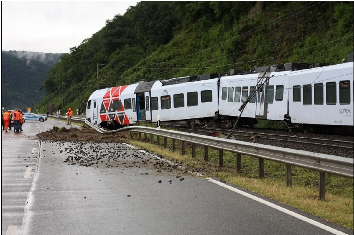
Abb. 91: Entgleister Zug in Folge eines Starkregen induzierten Murgangs am 25.06.2016 bei Bacharach (Foto: R. Kirchhoff, 25.06.2016).
