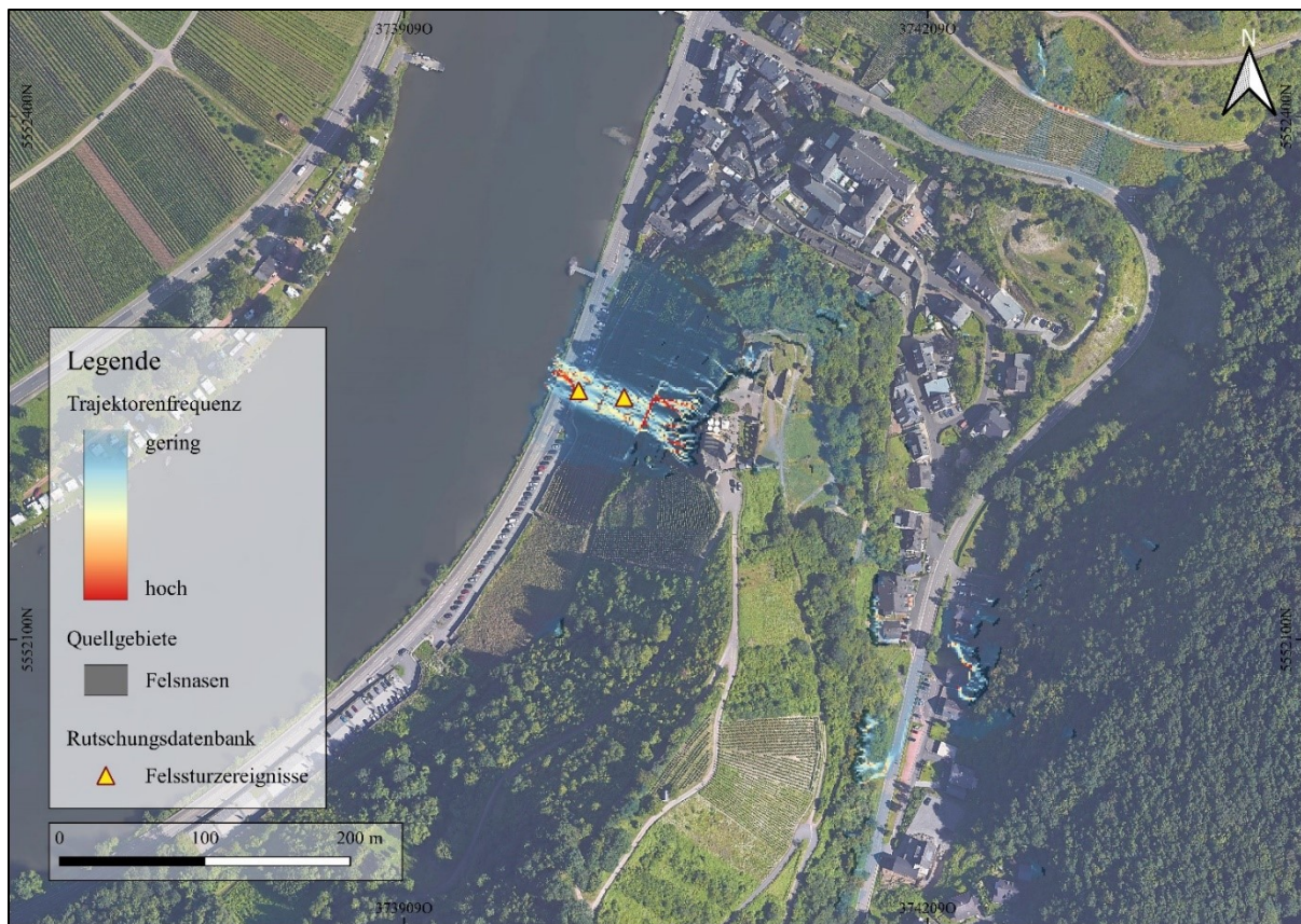
Abb. 78: Steinschlagmodellierung des Burgbergs bei Beilstein (Mosel) mit eingezeichneten Schadensfällen (HAGGE-KUBAT et al. 2021)
