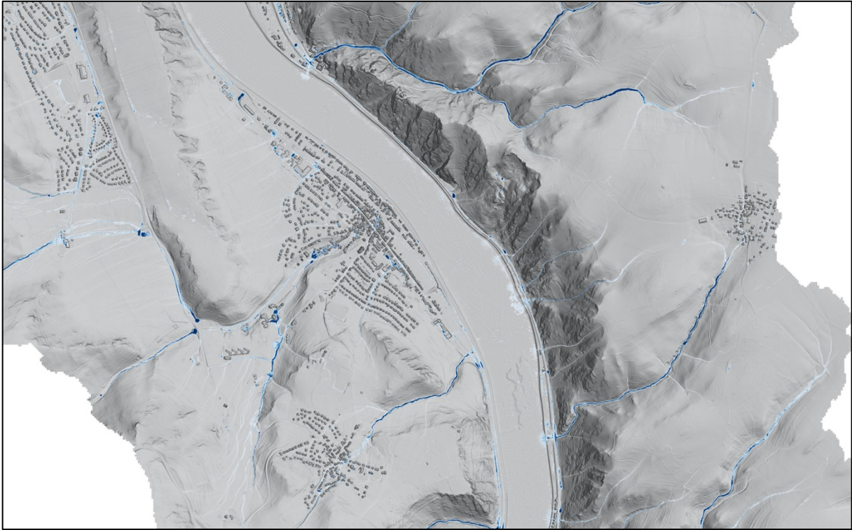
Abb. 73: Ausschnitt aus einer flächendeckenden Abflussmodellierung des Oberen Mittelrheintals bei Bad Salzig. Deutlich sichtbar sind die Strömungsfäden und Abflussakkumulationen, bei denen ein dunkleres Blau einen höheren Abflusswert darstellt
