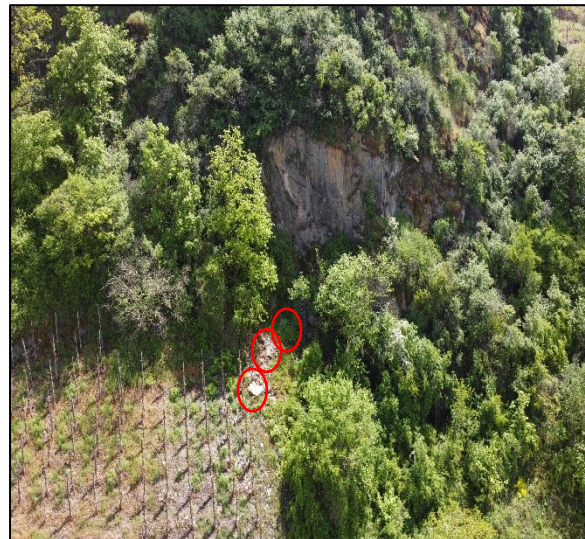
Abb. 80: Drohnenaufnahme der offenen Felspartie unterhalb der Burg Metternich mit hervorgehobenen stummen Zeugen (HAGGE-KUBAT et al. 2021)
