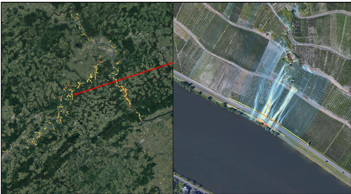
Abb. 88: Flächendeckende Modellierung der VulWay-Segmente am Mittelrhein und Moseltal im Maßstab 1:2500000 mit typischem Beispiel für die lokale automatisierte Ermittlung eines gefährdeten Straßenabschnittes an der Mosel
