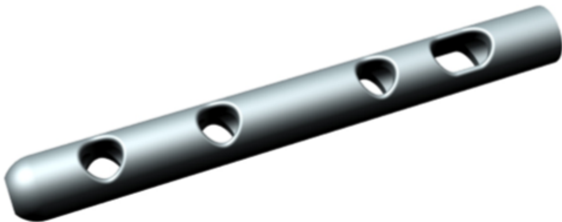
Abbildung 23 Intraossäres Nagelimplantat in 3D-CAD (computer-aided design), von R. Helfrich, Hochschule RheinMain,
