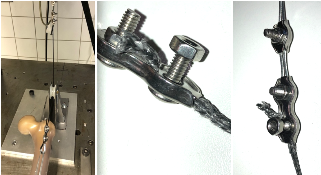
Abbildung 53 Kunststofffaden, links: eingespannt im Versuchsaufbau, mitte und rechts: Versagen des Kunststofffadens nach Lösen der Mutter zur Begutachtung
