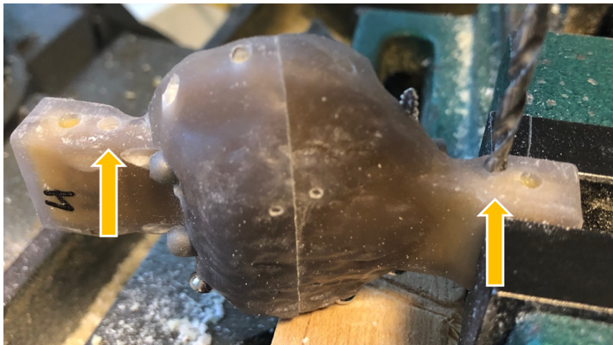
Abbildung 49 Aufhängeloch in den vise tabs
