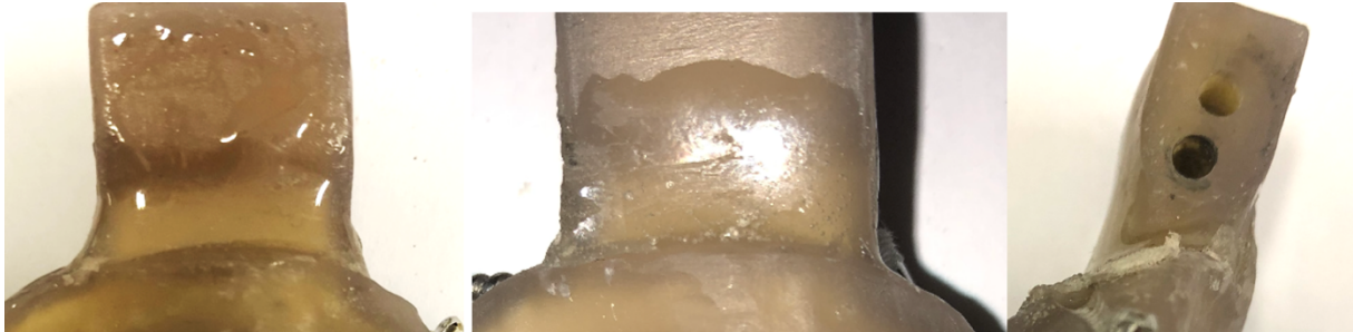
Abbildung 51 Epoxydharzverstärkung am proximalen vise tab (dorsal, ventral, seitlich)
