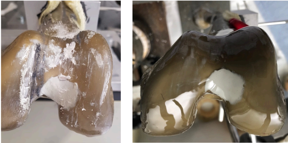
Abbildung 47 PMMA gefülltes Loch des Femurs, links: Abnutzung des Materials, rechts: Epoxydharzversiegelung
