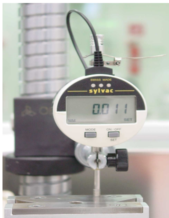
Abb. 6-3 Fotografie der Messeinheit zur Bestimmung der Kragenhöhe.
