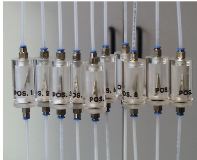
Abb. 9-9 Positionierung der BIEE vom Typ 1 in den Schlauchleitungen des Schlauchmodells.
