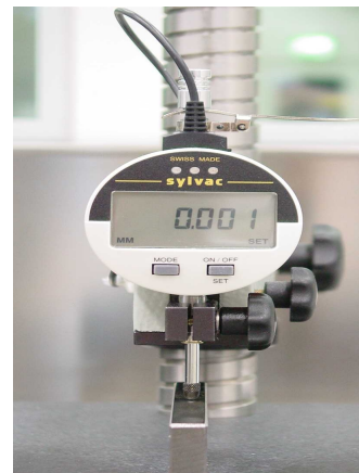
Abb. 6-4 Fotografie der Messeinheit zur Bestimmung der Schichtdicke.
