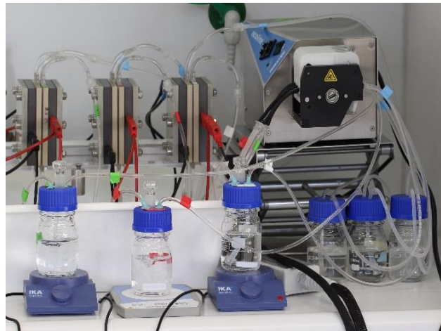
Abbildung 26: Die Filterpressenzellen in Betrieb bei diskontinuierlicher Prozessführung
