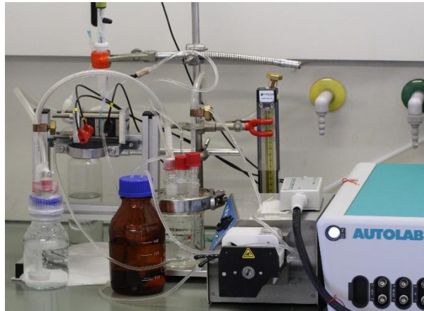
Abbildung 29: Aufbau zum chemischen CO 2 Nachweis während der elektrochemischen Modifikation der Aktivkohle
