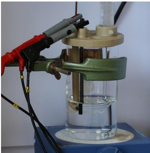
Abbildung 16: Zelle für zykovoltammetrische Messungen an Kohlenstoff-Pulver-Elektroden
