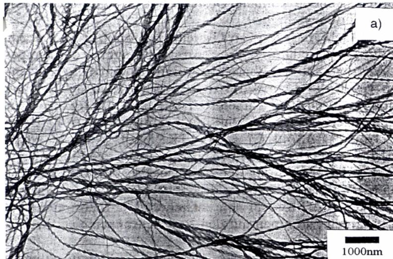
**Abbildung 1.2:** Netzwerk eines Gelbildners: TEM-Aufnahmen eines lockeren Acetonitril-Gels mit 1 mmol Trans-(1R,2R)-diaminocyclohexan mit 7000 facher Vergrößerung.<sup>27</sup>
