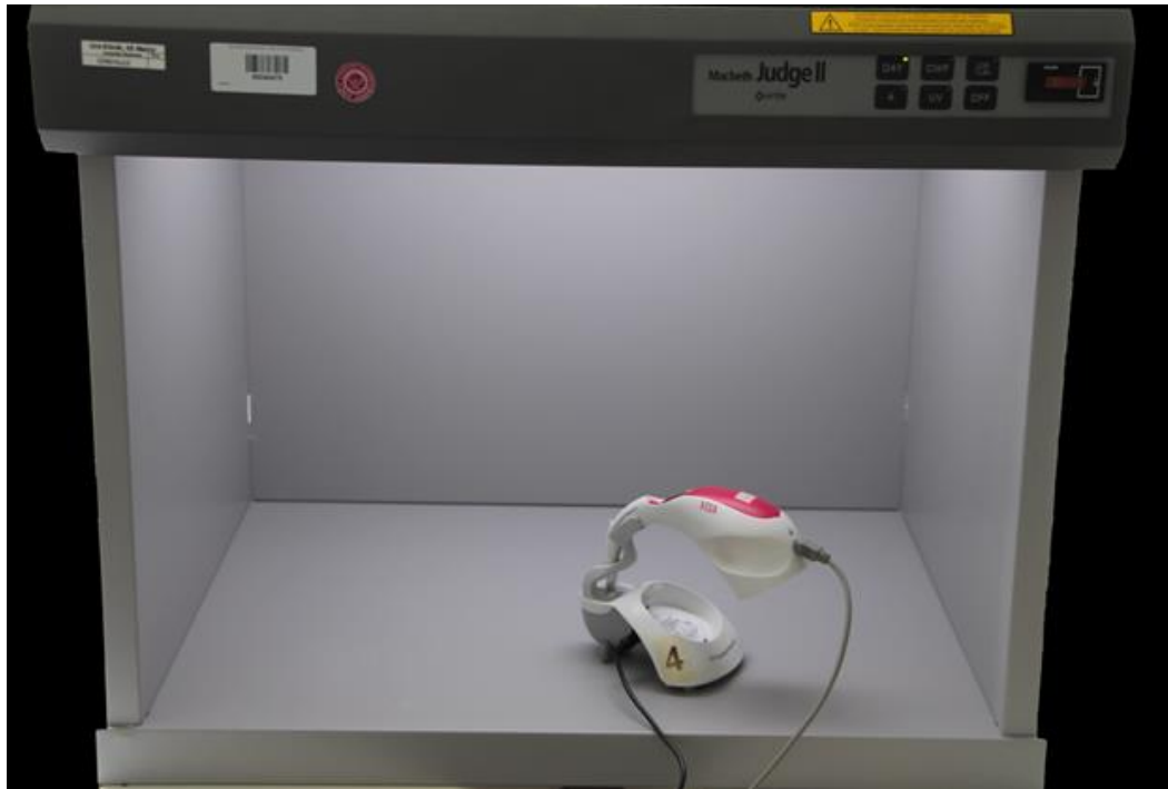
Abbildung 16: VITA Easyshade® Advance 4.0 in einer Lichtkammer.
