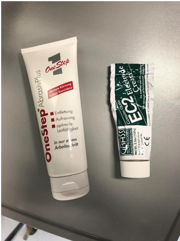
Abbildung 10: Peeling und Klebeleitpaste für die EEG-Montage
