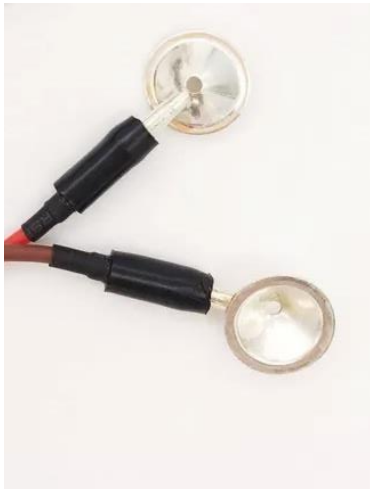
Abbildung 11: Silver-Cup-Elektroden mit EEG-Elektrodenkabel.
