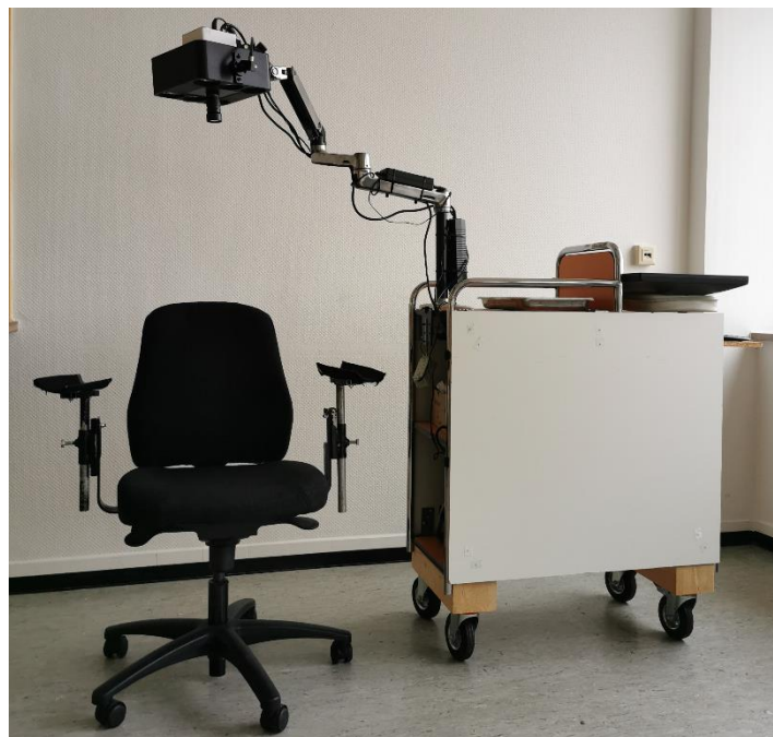
Abbildung 7 Versuchsstuhl mit Hyperspektralkamera. Links abgebildet ist die der selbst gebaute Versuchsstuhl. Die Armschienen sind in alle Richtungen verstellbar. Rechts abgebildet ist die TTC mit Teleskoparm.
