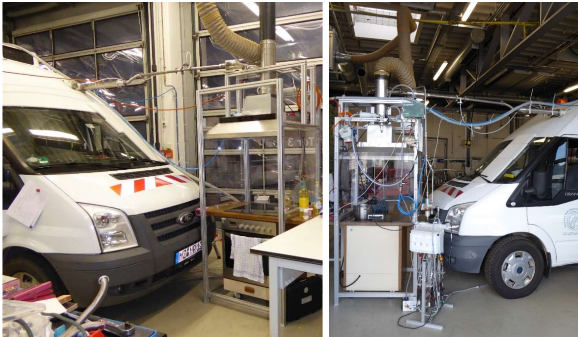
Abbildung 14: Küchenaufbau mit Elektroherd und Dunstabzug mit Verbindung zu MoLa und AERTRACC-Sammler (vorne und hinten).
