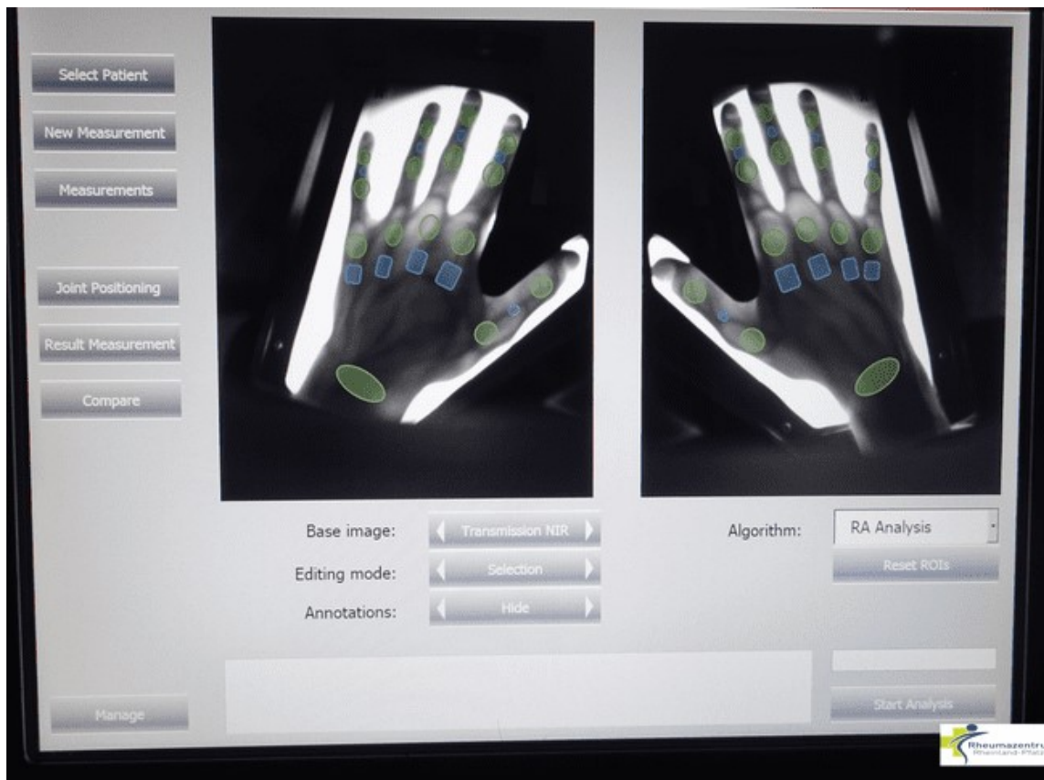
Abbildung 6: Mögliche Positionierung der Gelenke vor der HandScan-Analyse, grüne Markierungen sind die zu untersuchenden Gelenke und blau markiert sind Referenzregionen, Bild: Rheumazentrum, Rheinland-Pfalz.
