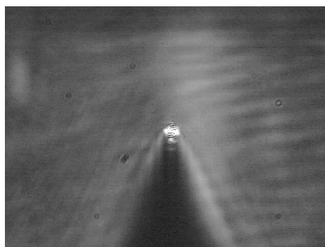
Abbildung 3.7.: Aufnahme mit CCD-1 aus Aufbau 3 (siehe Abbildung 3.4). Es ist der Schatten des AFM-Cantilevers zu erkennen und der Fokus des konfokalen Fluoreszenzmikroskops, der auf die Spitze dieses Schattens verfahren wurde.
