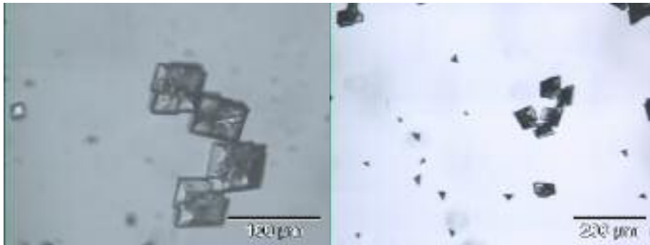
Abbildung 66 Mikroskopaufnahme der Kristalle, die nach 20stündiger Kristallisationsdauer unter einer polymerisierten M2-Monoschicht entstehen
