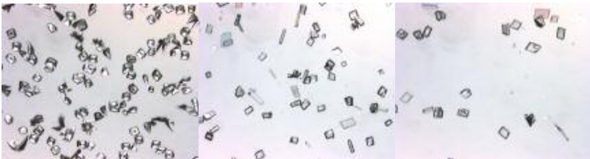
Abbildung 49 Optische Mikroskopaufnahme einer auf 20mN/m komprimierten Monoschicht nach Übertrag auf Glas; rechts) Mischverhältnis Stearinsäure zu M1 50 mol%, Mitte) 40 mol%, rechts) 10 mol%
