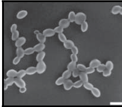
Abbildung 1.2 SEM-Bild ellipsoidaler Nanopartikel aus einem flüssigkristallinen Hauptkettenpolyether (der weiße Balken entspricht 200 nm)
