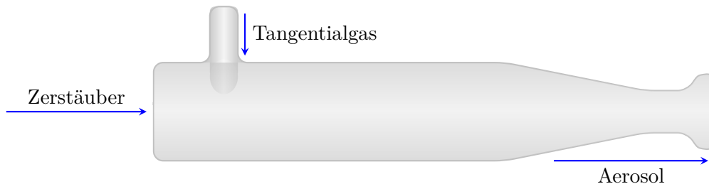
Abbildung 1.6: Aerosoltransportkammer mit tangentialem Einlass für ein Hilfsgas.
