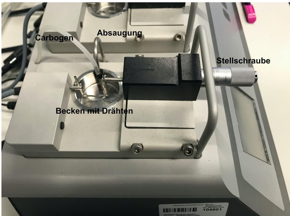
Abbildung 6 Aufbau Myograph.
