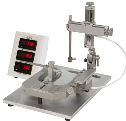
Abbildung 19: Bildliche Darstellung eines KOPF-Stereotakten mit zugehöriger Stereotaxie-Einheit zum vereinfachten Ablesen der Koordinaten (Abbildung von KOPF® instruments).
