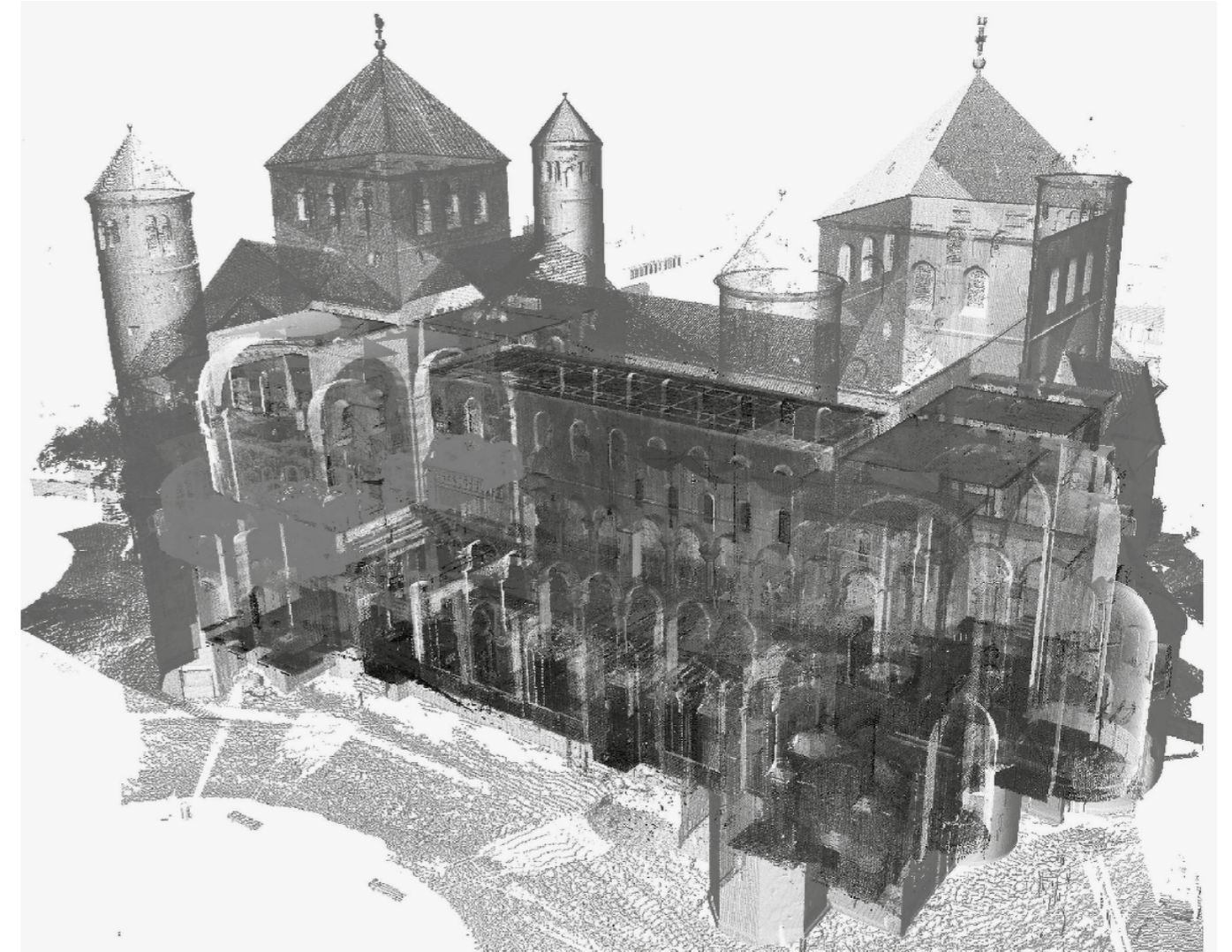
Abb. 7 Ein Ergebnis der Vermessungsarbeiten an der Michaeliskirche in Hildesheim. Zusammengeführte Punktwolken von vielen Standpunkten, die in- und außerhalb des Gebäudes gemessen wurden.
