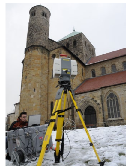
Abb. 6 Terrestrisches Laserscanning im Außenbereich der Michaeliskirche in Hildesheim; Foto: i3mainz, CC BY-SA 4.0
