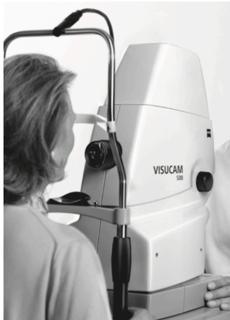
Abb. 7: Visuscam Pro NM, TM, a , Funduskamera (Quelle: Broschüre VISUCAM 500 Carl Zeiss AG, Jena, Germany, (89))
