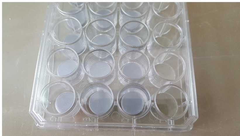
Abbildung 3: PLA-Scheiben vorbereitet zur Zellaussaat in 24-Well-Suspensionskulturplatte nach Absaugen des spezifischen Mediums Quelle: Eigene Darstellung
