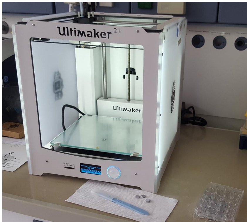
Abbildung 2: 3D- Druck eines Scheiben-Modells mit dem 3D-Drucker Ultimaker 2+ vor Abtrennen des PLA-Überstands Quelle: Eigene Darstellung
