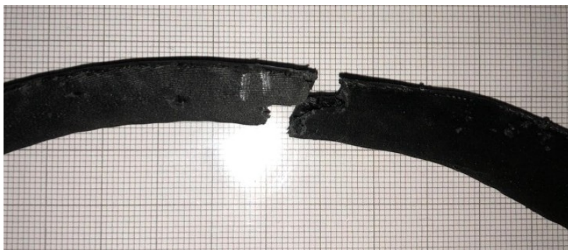
ABILDUNG 29 3-PUNKT-BIEGEVERSUCH – KRAFT-WEG-DIAGRAMM (OBEN) UND FRAKTUR (UNTEN) DER MODELLRIPPE (GRID-INFILL, INFILL-DICHTE: 25 %, AUSSENHÜLLDICKE: 1 MM, MATERIAL: XT-CF20)
