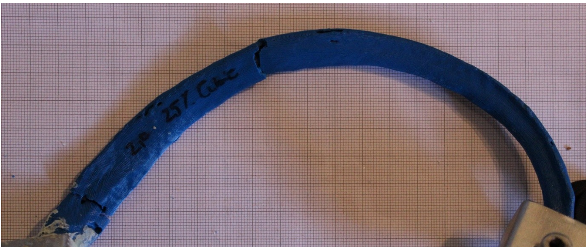
ABBILDUNG 20 3-PUNKT-BIEGEVERSUCH – KRAFT-WEG-DIAGRAMM (OBEN) UND FRAKTUR (UNTEN) DER MODELLRIPPE (INFILL-PATTERN CUBIC, INFILL-DICHTE: 25 %, AUSSENHÜLLDICKE: 2 MM, MATERIAL: POLYLACTID (PAL))
