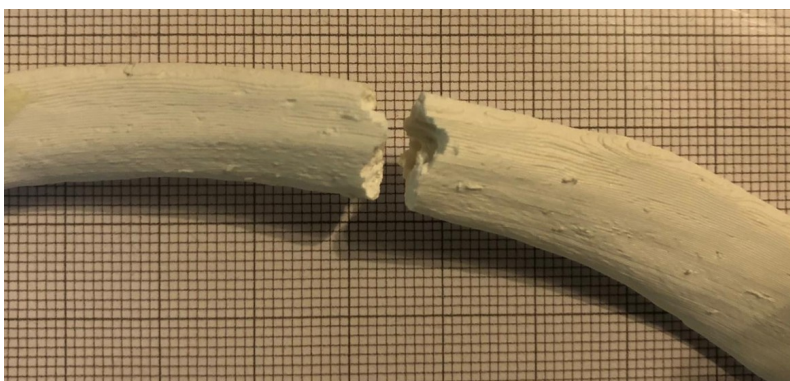
ABBILDUNG 28 3-PUNKT-BIEGEVERSUCH – KRAFT-WEG-DIAGRAMM (OBEN) UND FRAKTUR (UNTEN) DER MODELLRIPPE (GRID-INFILL, INFILL-DICHTE: 25 %, AUSSENHÜLLDICKE: 1 MM, MATERIAL: GREEN-TEC®)
