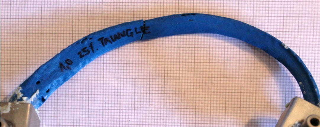
ABBILDUNG 13 3-PUNKT-BIEGEVERSUCH – KRAFT-WEG-DIAGRAMM (OBEN) UND FRAKTUR (UNTEN) DER MODELLRIPPE (INFILL-PATTERN TRIANGEL, INFILL-DICHTE: 25 %, AUSSENHÜLLDICKE: 1 MM, MATERIAL: POLYLACTID (PAL))
