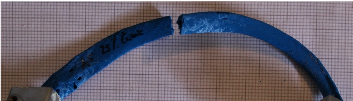
ABBILDUNG 17 3-PUNKT-BIEGEVERSUCH – KRAFT-WEG-DIAGRAMM (OBEN) UND FRAKTUR (UNTEN) DER MODELLRIPPE (INFILL-PATTERN CUBIC, INFILL-DICHTE: 25 %, AUSSENHÜLLDICKE: 1,5 MM, MATERIAL: POLYLACTID (PAL))
