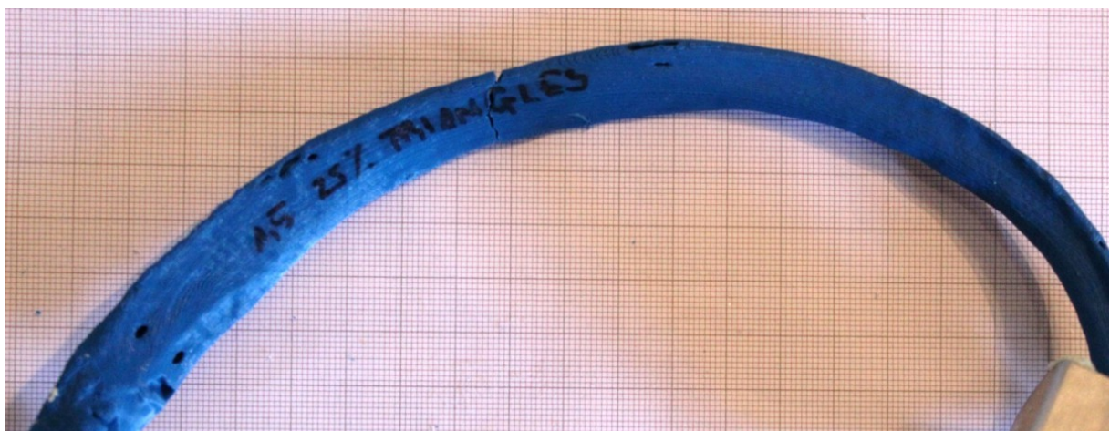
ABBILDUNG 16 3-PUNKT-BIEGEVERSUCH – KRAFT-WEG-DIAGRAMM (OBEN) UND FRAKTUR (UNTEN) DER MODELLRIPPE (INFILL-PATTERN TRIANGEL, INFILL-DICHTE: 25 %, AUSSENHÜLLDICKE: 1,5 MM, MATERIAL: POLYLACTID (PAL))
