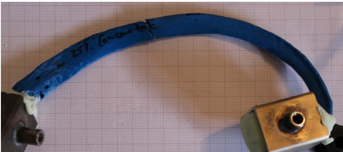
ABBILDUNG 21 3-PUNKT-BIEGEVERSUCH – KRAFT-WEG-DIAGRAMM (OBEN) UND FRAKTUR (UNTEN) DER MODELLRIPPE (INFILL-PATTERN CONCENTRIC, INFILL-DICHTE: 25 %, AUSSENHÜLLDICKE: 2 MM, MATERIAL: POLYLACTID (PAL))
