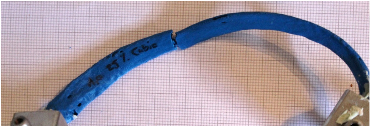
ABBILDUNG 14 3-PUNKT-BIEGEVERSUCH – KRAFT-WEG-DIAGRAMM (OBEN) UND FRAKTUR (UNTEN) DER MODELLRIPPE (INFILL-PATTERN CUBIC, INFILL-DICHTE: 25 %, AUSSENHÜLLDICKE: 1 MM, MATERIAL: POLYLACTID (PAL))
