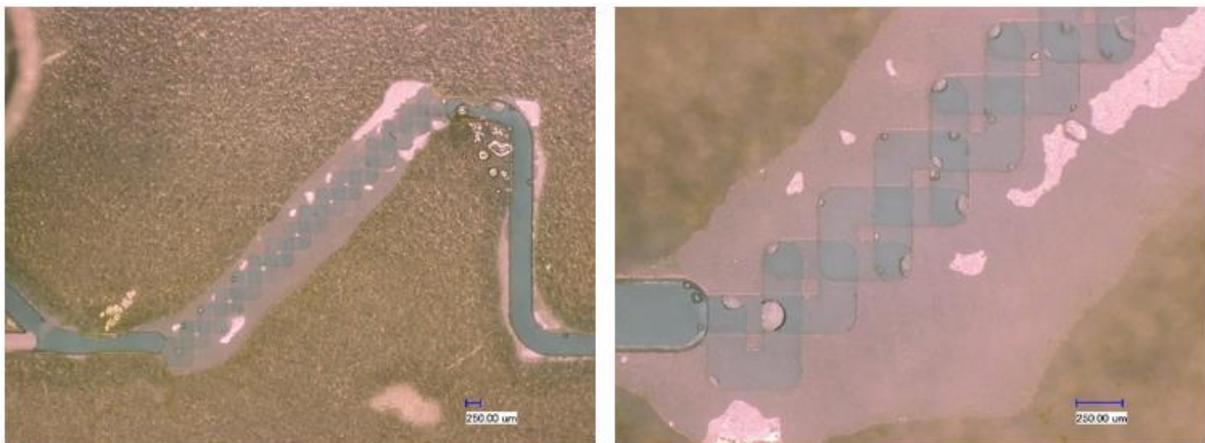
**Abbildung 3. 7:** Foto der mikrofluidischen Mischer Struktur nach Two-Layer-Crossing-Channel Design. Die Fotos wurden nach Zusammenschweißen der Bauteile mit dem Digitalmikroskop Keyence aufgenommen.
