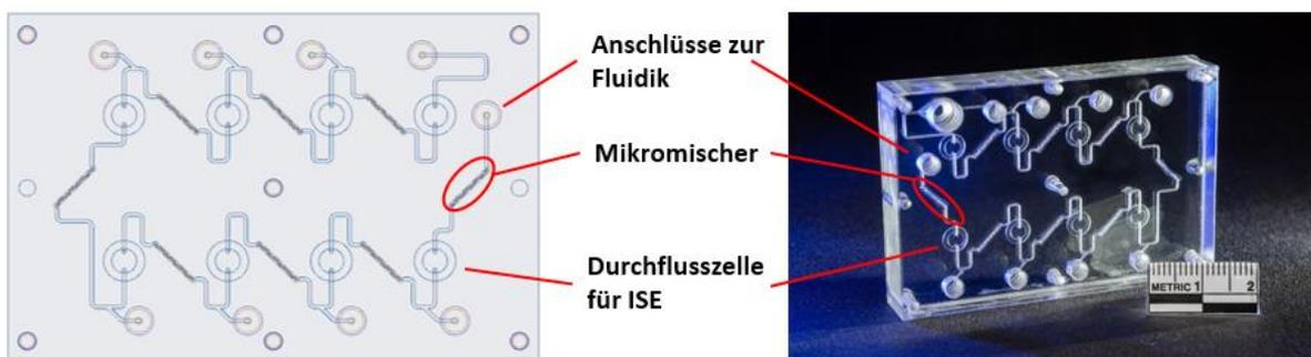
**Abbildung 3. 1:** Darstellung der mikrofluidischen Plattform. Auf der linken Seite ist das Schema der mikrofluidischen Kanäle, Mischer und Durchflusszellen für Sensoren in einer CAD-Zeichnung abgebildet. Der gefertigte Chip aus transparentem Polycarbonat ist auf der rechten Seite dargestellt.
