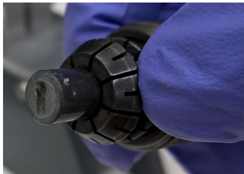
Abbildung 107 – Zerklüftete Eindiffusionsfläche nach der 237 Np-Eindiffusion.
