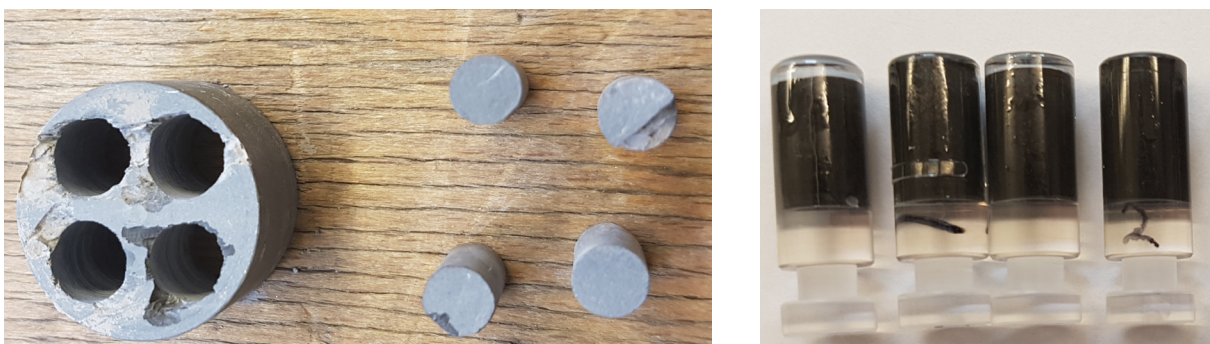
Abbildung 105 – Tonkern und herausgedrehte Opalinustonstifte (links), in PMMA-Probenhalter eingeklebte Opalinustonstifte (rechts).
