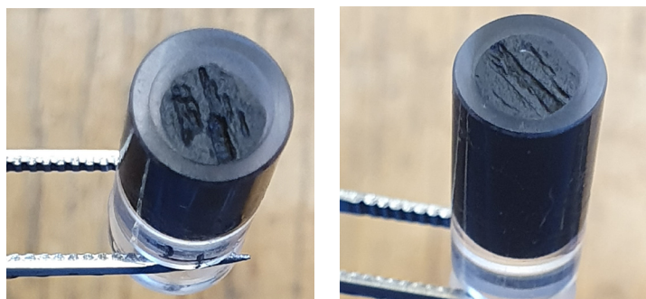
Abbildung 106 – Zerklüftete Eindiffusionsfläche nach der ersten Vorkonditionierung der Opalinustonproben.
