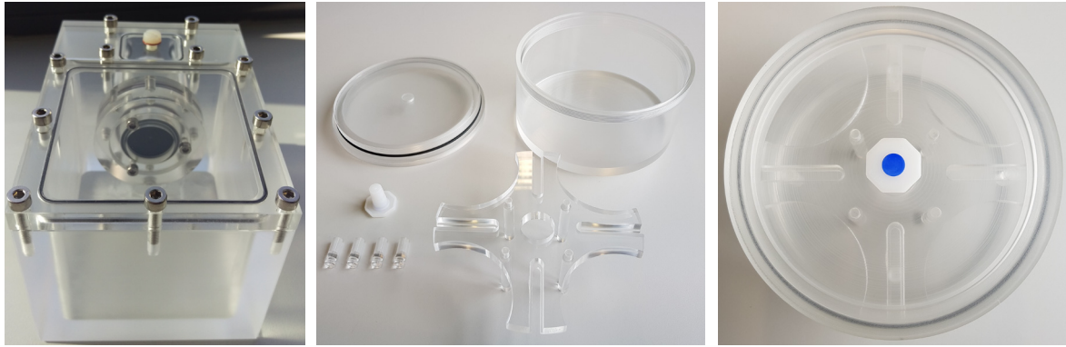
Abbildung 91 – Schlauch- und filterfreie Diffusionszellen: Setup 1 (links), Einzelteile des Setup 2 (mittig), zusammengesetztes Setup 2 (rechts).
