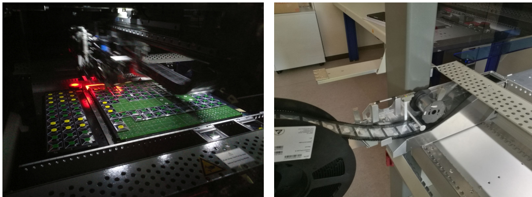
(a) Pick-and-Place-Maschine während einer Bestückung eines HBU-Boards.
