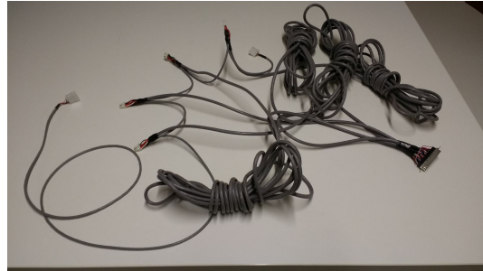
(b) Stromversorgungskabel für HBU-Boards im Teststand [153].
