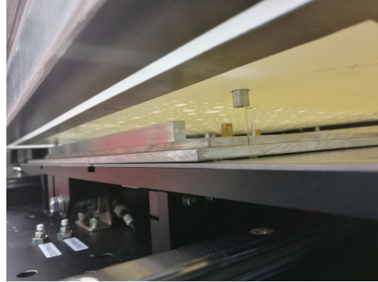
(b) HBU-Board-Halterungsplatte auf Adapterplatte des Siebdruckers (Die Schablone ist dabei noch nicht ausgerichtet, s. Acrylglas-Pin).
