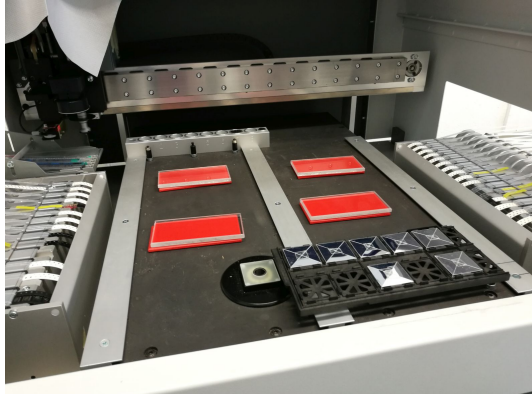
(a) Spacer zur Höhenjustierung der Halterungsplatte.
