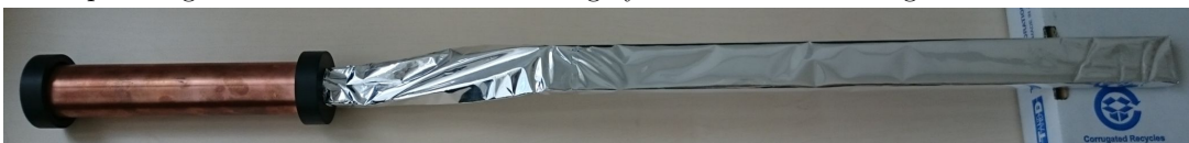
(d) Verbundene Triggereinheit eingepackt in Reflektorfolie.
