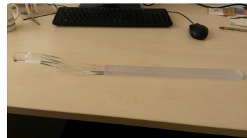
(c) Szintillatorstreifen mit angeklebten Lichtleiter.
