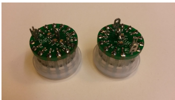
(a) PMT-Sockel mit Spannungsteiler-PCB.
