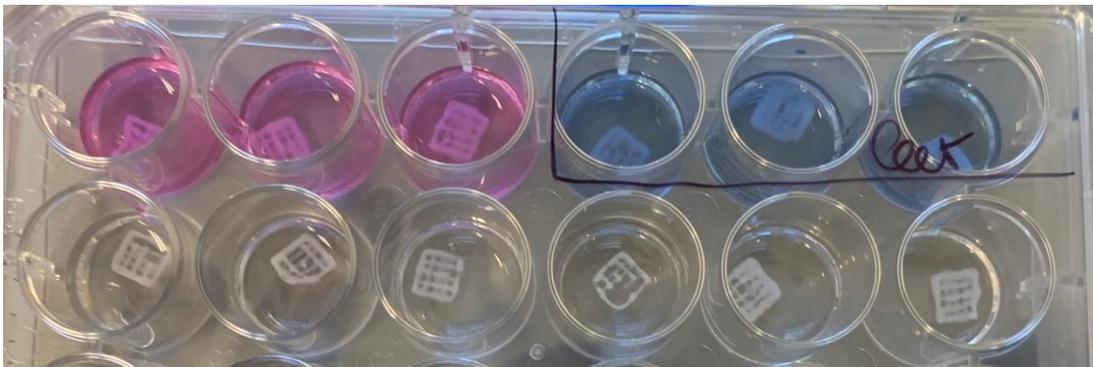
**Grafik 20**, Beispielhafte gedruckte Konstrukte Bi-Kultur in Cellink Bioink, obere Zeile mit AlamarBlue nach 24 h Einwirkzeit. Die Konstrukte oben links sind mit Bi-Kultur gefüllt, oben rechts die Leerkontrollen zum Vergleich. Die Bi-Kultur-beladenen Konstrukte zeigen eine deutliche rosa Verfärbung des Zellmediums.
