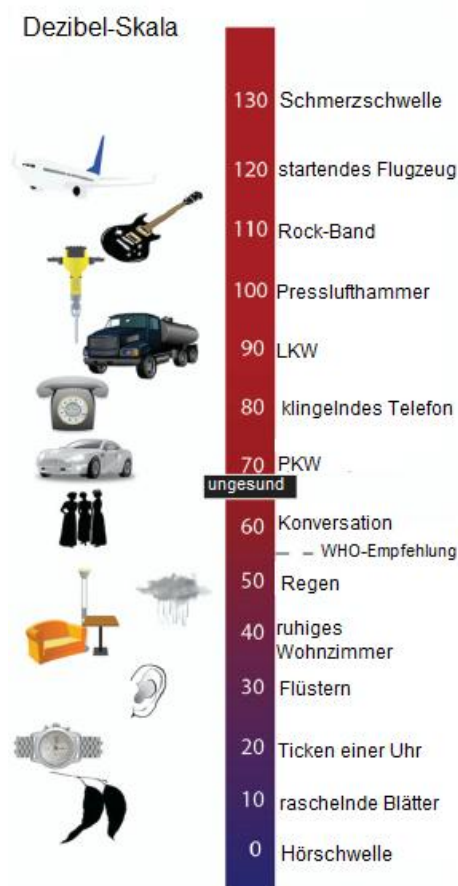
Abbildung 5.1 Beispiele für Umgebungslärmquellen mit den entsprechenden Schalldruckpegeln in dB(A).
