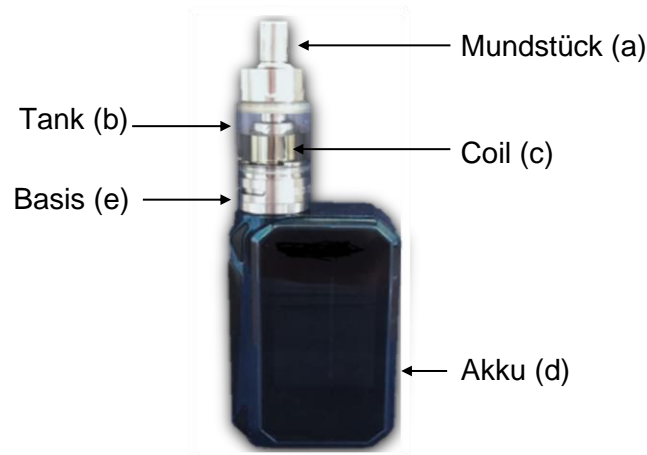
Abbildung 1: Aufbau der E-Zigarette ( mod )
