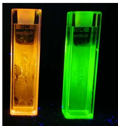
Abbildung 3.10: Leere, nicht gespülte Küvetten einer PDI-DC-NPL- (links) und einer NPL-Dispersion (rechts) in Toluol unter UV-Licht (365 nm).
