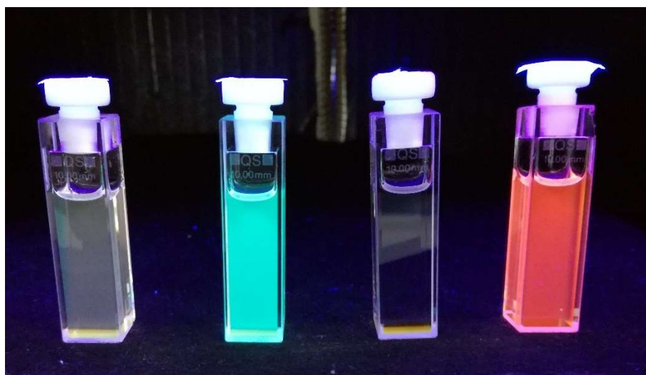
Abbildung 2.3: Toluolische Dispersionen der Synthesestufen unter UV-Licht (365 nm). Von links nach rechts: reine CdSe-Kerne, CdSe-Kerne mit 2 MLs ZnS, beschichtete Partikel mit Mn 2+ auf der Oberfläche und finale Partikel mit Mn 2+ in der ZnS-Schale.
