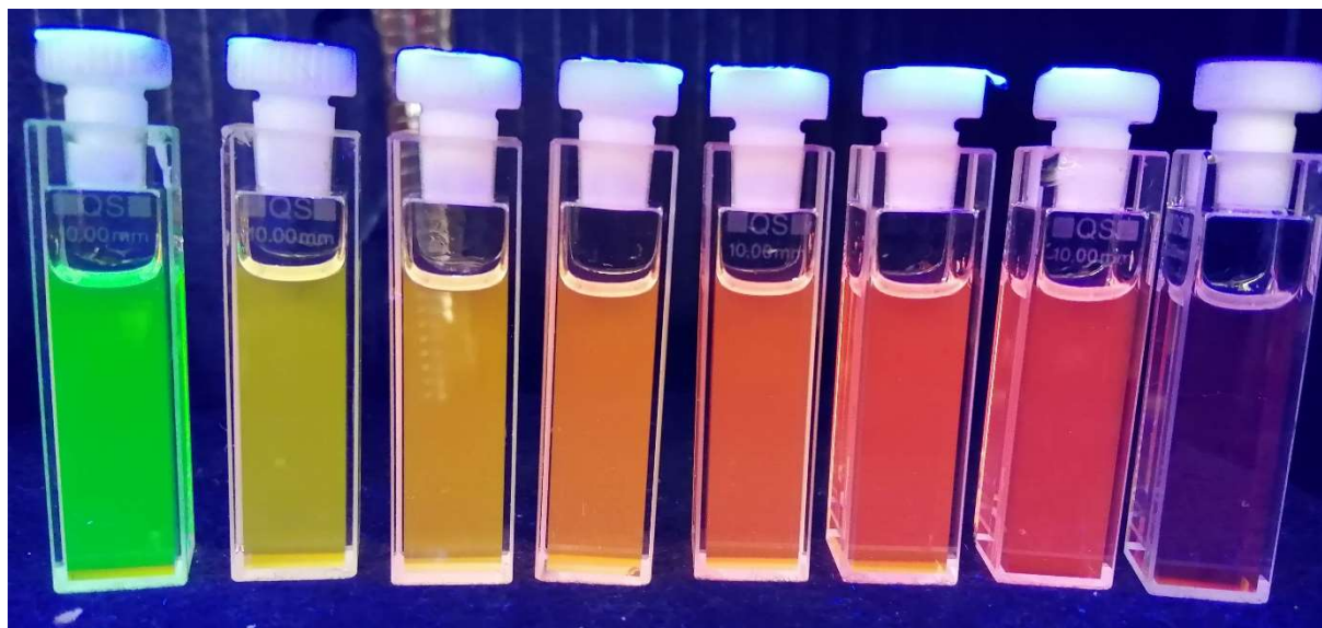
Abbildung 3.9: Testreihe der PDI-DC-NPL-Komplexe unter UV-Licht (365 nm). Von links nach rechts: Referenz, 5 FS/NPL, 10 FS/NPL, 20 FS/NPL, 50 FS/NPL, 100 FS/NPL, 150 FS/NPL, PDI-DC in Toluol.
