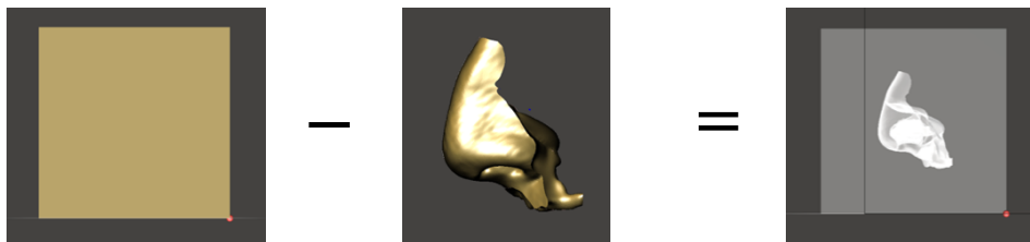
Abbildung 34: Negativmodell der intakten Nase (Gussform) . Durch die Boolesche Operation wird von der Box (links) das intakte Nasenmodell (Mitte) subtrahiert. Rechts: Transparentansicht der Booleschen Operation (Negativmodell der Nasenepithese) (Quelle: eigene Bilder).
