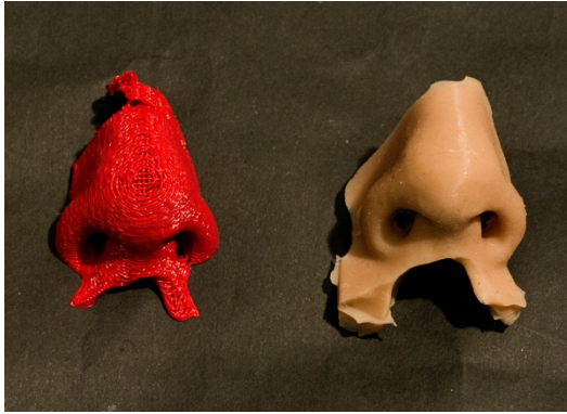
Abbildung 45: Direkter 3D Druck vs. CAD/CAM. In rot zu erkennen das Ergebnis des direkten 3D Drucks mit Silikon. Rechts das Endergebnis dieser Arbeit (Quelle: eigene Bilder).
