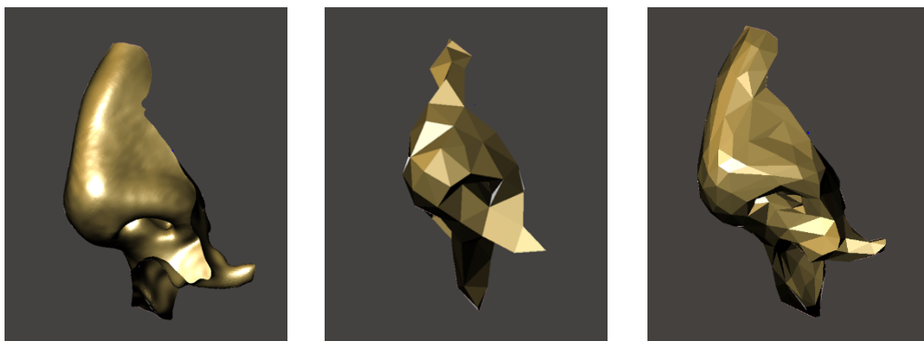
Abbildung 8: Prinzip der STL Formatierung. Bild links: das unbearbeitete Bild soll in das STL Format gebracht werden. Bild Mitte: Das Objekt wird über eine definierte Anzahl an Dreiecken abgebildet. Bild rechts: Je mehr Dreiecke in das Objekt gelegt werden, desto genauer kann dieses abgebildet werden (Quelle: eigene Aufnahmen).
