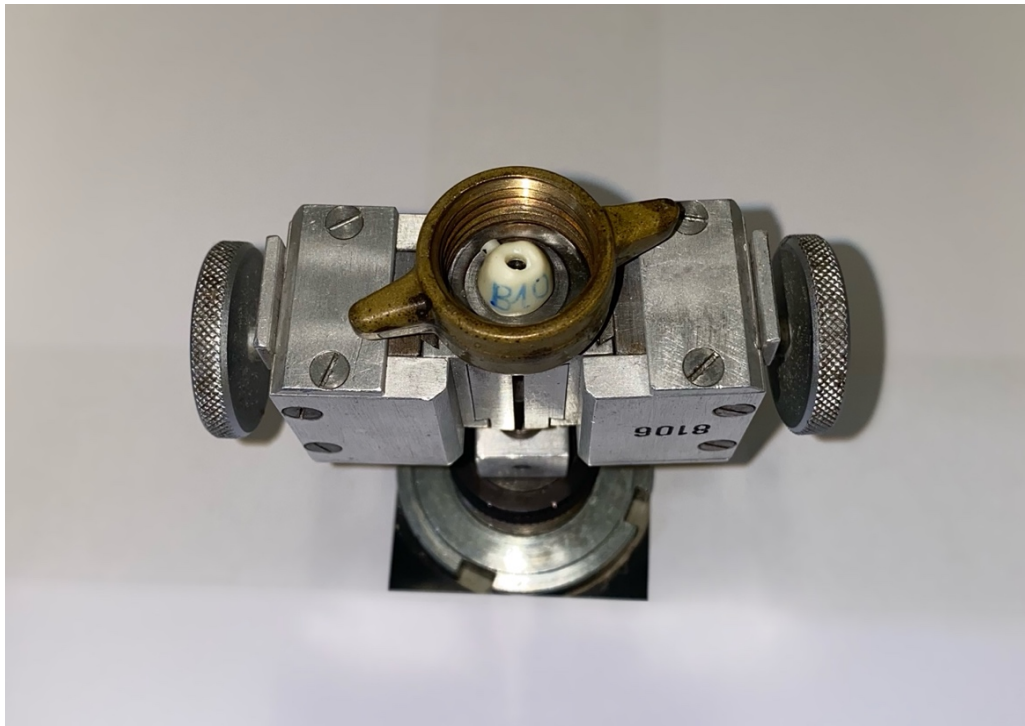
Abbildung 17: Aufsicht auf den Keilspannprobenhalter mit eingespannter Probe
