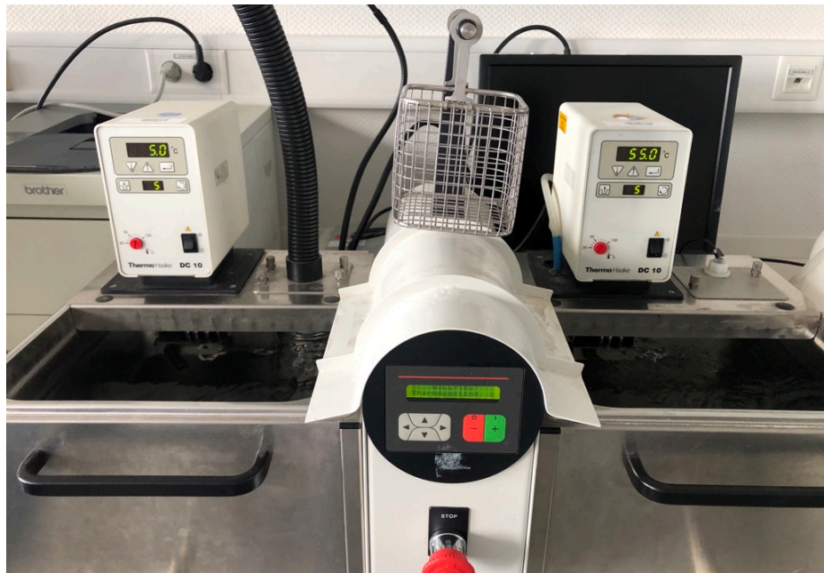
Abbildung 16: Thermozykliegerät mit temperierten Wasserbädern
