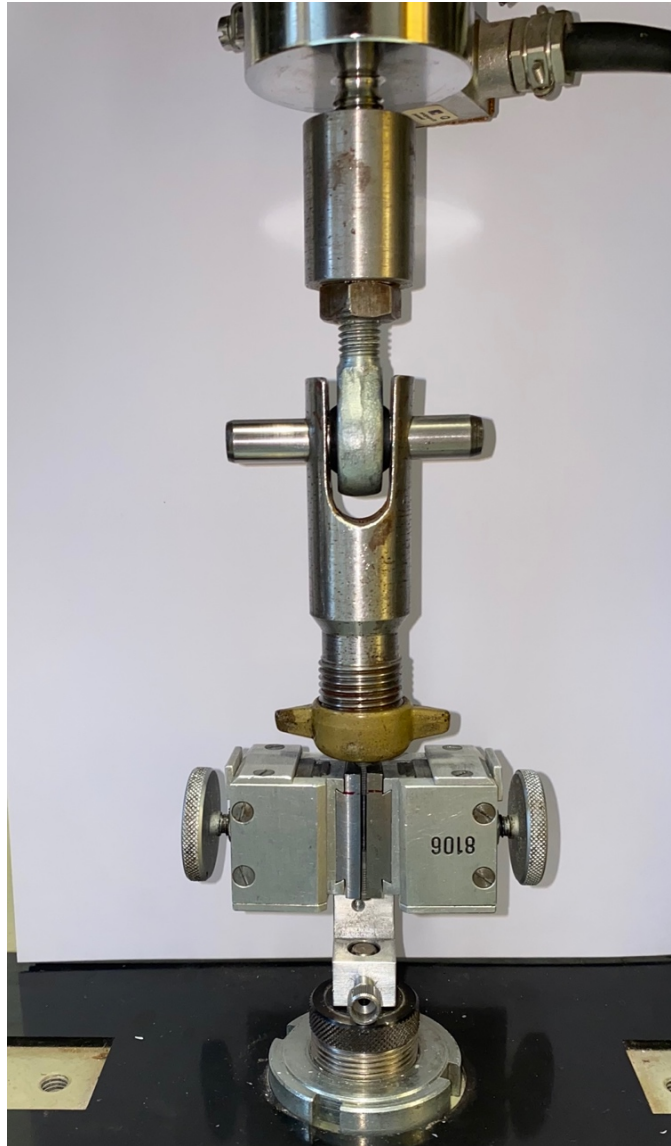
Abbildung 18: Haltevorrichtung (oben) und Keilspannprobenhalter (unten)
