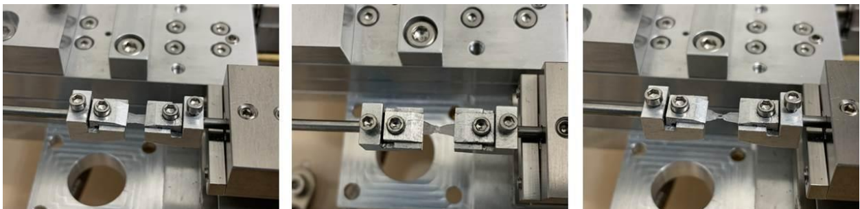
Abbildung 37: Sequenz des Bruchs von A während eines Zugversuchs.
