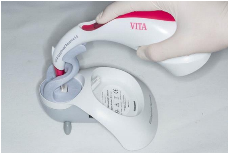
Abbildung 24: Kalibrierung des VITA Easyshade® Advance 4.0
