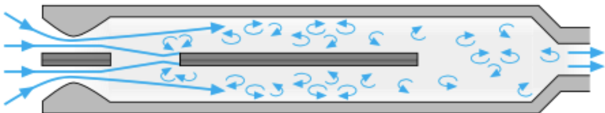
Abbildung 4: Flussmuster im Nasenmodell mit einer Nasenseptumperforation bei einer Flussgeschwindigkeit von 200ml/s
