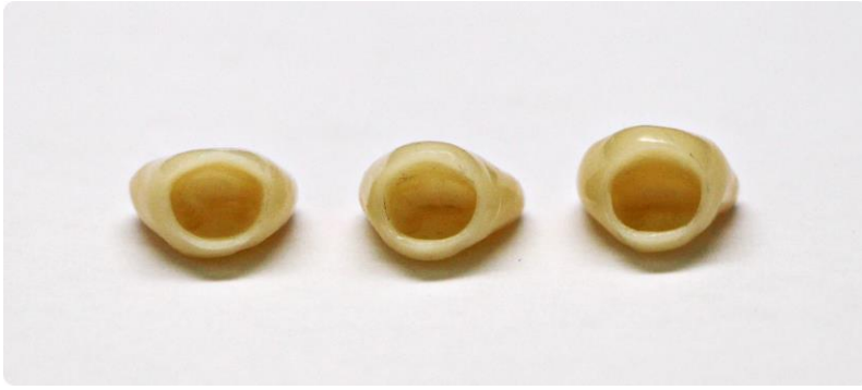
Abbildung 9 IPS e.max Kronen mit Blick auf das „Kroneninnere“ zur Veranschaulichung der verschiedenen Kronendicken, v.l.n.r.: 1,0 mm, 1,5 mm und 2,0 mm
