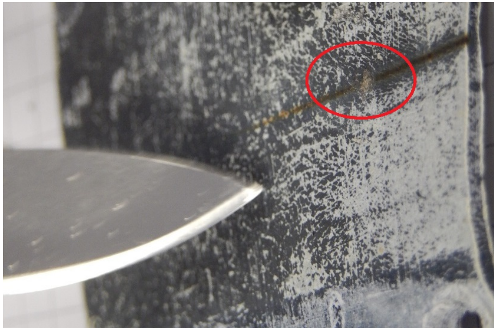
Abbildung 6.23.: Untersuchung des ausgebauten Lithiumtargets nach der Bestrahlung. Der dunkle Streifen auf der Oberfläche wurde mit einem Skalpell abgeschabt und nach minimalem Abtrag konnte metallisches Lithium gefunden werden.
