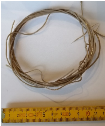
Abbildung 40.: Selbst hergestelltes PETG-Filament mit 2 Gew. % Ceroxid-Nanopartikel-Zusatz (links). Filament-Extruder, gefertigt von der Chemie-Werkstatt der Uni Mainz unter Anleitung von Dr. Tobias Johann (AK Frey, JGU Mainz), nach dem Vorbild des Lyman-Extruders. (rechts). [186]
