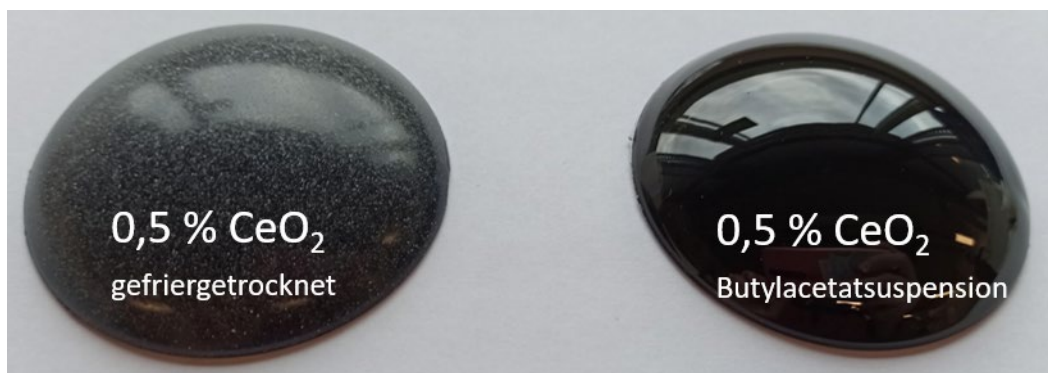
Abbildung 53.: In hochglänzenden, farblosen PUR-Lack eingebettete Ceroxidnanopartikel. Es wurden jeweils 0,5 Gewichtsprozent Ceroxid-Nanopartikel in Lack eingerührt. Das Cerdioxid wurde als gefriergetrockneter Feststoff zugegeben (links) und als Suspension in Butylacetat (rechts). Der Farblose Lack wurde auf schwarze Prüfkörper aufgetragen.
