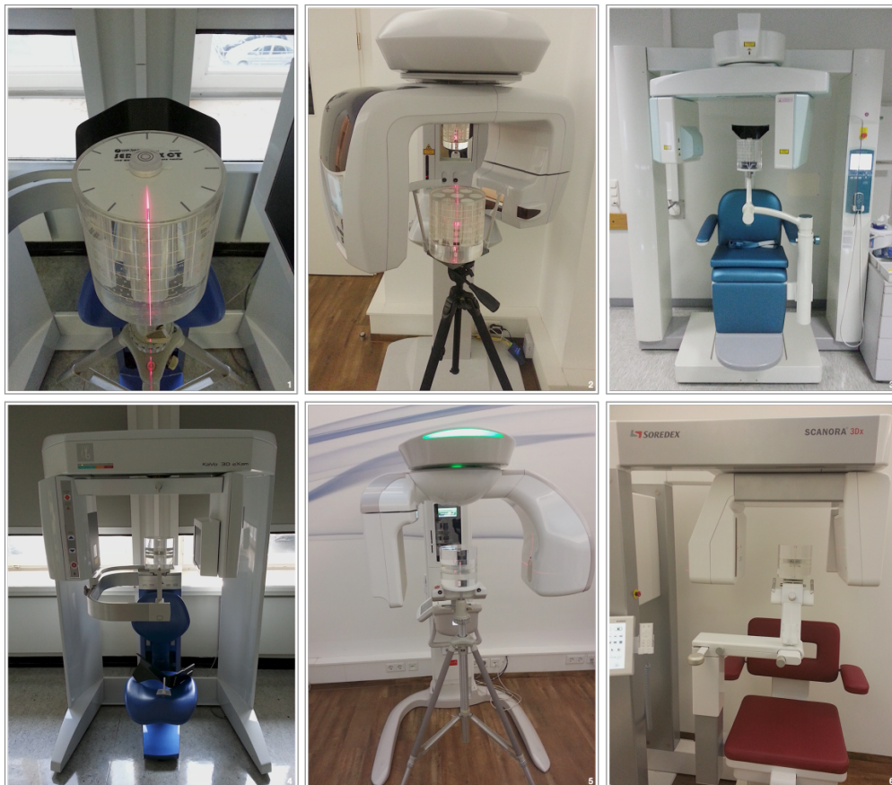
Abbildung 4 Positionierung der beiden Prüfkörper an unterschiedlichen DVT-Geräten; 1: SedentexCT IQ & 3D eXam, 2: SedentexCT IQ & Veraviewepocs 3D, 3: SedentexCT IQ & 3D Accuitomo MCT-1, 4: Quart DVT_ap & 3D eXam, 5: Quart DVT_ap & Pax Duo 3D, 6: Quart DVT_ap & Scanora® 3Dx
