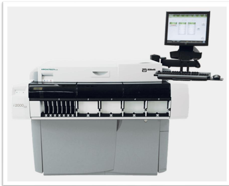
Abbildung 5: ARCHITECT i2000sr – Messeinheit, Höhe: 121,9 cm, Breite: 154,9 cm, Tiefe: 124,5 cm, Gewicht: 490,3 kg, Probenkapazität: 135 (2).
