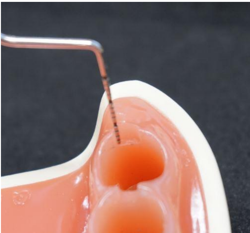
Abbildung 3.10: Messung der Frästiefe mittels Parodontalsonde in apikaler Richtung
