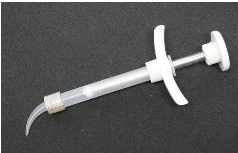
Abbildung 3.12: Applikationsspritze zum Einbringen der Silikone welche im 3M ESPE Pentamix ™ Lite (3M Oral Care, Espe Platz, 82229 Seefeld, Deutschland) angemischt werden müssen
