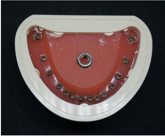
Abbildung 3.4: mittig angebrachtes Schraubengewinde zur Befestigung des Modells an einem Phantomkopf
