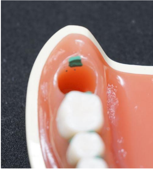
Abbildung 3.17: vorbereiteter künstlicher Parodontalspalt; Pressfahnen sowie Überschüsse wurden entfernt und anschließend der Kunststoffzahn wieder eingeschraubt
