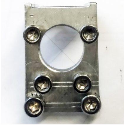
(a) Drahtkreuz aus 30\ \mu\text{m} dickem Wolframdraht.
