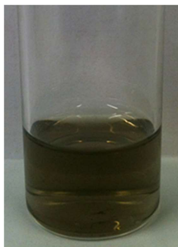
Abbildung 65: Aufnahme der stabilen Dispersion von C-PEG-funktionalisierten Pt@MnO-Nanoketten in Ethanol. Die Aufnahme erfolgte drei Tage nach der Funktionalisierung.
