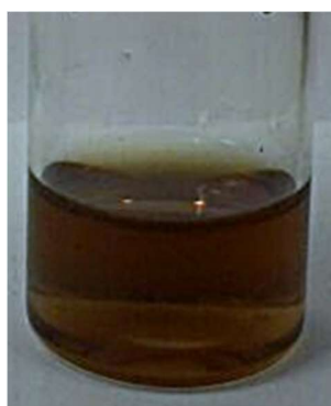
Abbildung 80: Aufnahme von stabil dispergierten MnO-Nanopartikeln in wässriger Kochsalzlösung, funktionalisiert mit TD-PEG 57 -PGG 12 . Die Aufnahme erfolgte drei Tage nach der Funktionalisierung.
