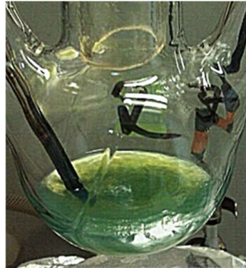
Abbildung 7: Aufnahme der Synthese von MnO-Nanopartikeln nach Erreichen der Höchsttemperatur von 317°C. Die klare Lösung mit grünlicher Färbung ist oft ein Zeichen für eine hochmonodisperse Probe.
