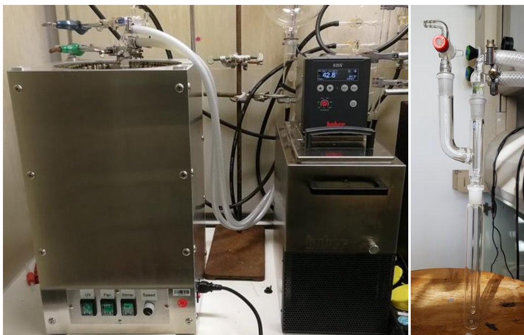
Abbildung 7: Aufbau der UV-Bestrahlungsapparatur mit regelbarer Temperaturkontrolle über einen Umwälzthermostat. Links: Vollständige Apparatur mit Rayonet-Photoreaktor, Quarzreaktionsgefäß und mit dem Umwälzthermostat verbundener Kühlfinger. Rechts: Reaktionsgefäß bestehend aus einem Quarzrohr mit aufgesetztem Y-Stück für Inertgasatmosphäre und Kühlfinger.
