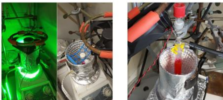
Abbildung 4.6: Exemplarischer Reaktionsaufbau für die Bestrahlung mit LED-Streifen. Links: Verschlussenes Röhrenchen. Rechts: Durchleiten eines O 2 -Stroms über eine Glaskapillare, die durch eine Schraubverbindung (Quickfit) gesteckt wurde. Der Schlauch auf der rechten Seite diente zur Abfuhr des Gasstroms.
