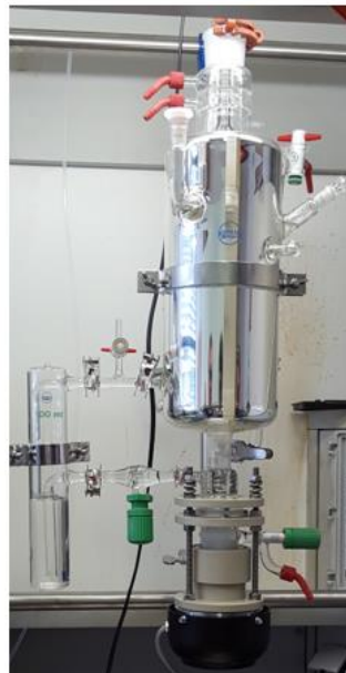
Abbildung 4.3: Links: Schematische Darstellung der Funktionsweise des UV-Fallfilmreaktors. Rechts: Fotos des Reaktors (die Fotos wurden beim Aufbau und Test des Reaktors gemacht, sodass nicht alle Bauteile gezeigt sind).
