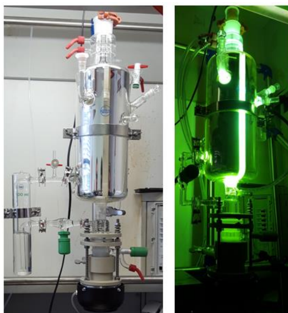
Abbildung 2.4: Links: Schematische Darstellung der Funktionsweise des UV-Fallfilmreaktors. Rechts: Fotos des Reaktors (die Fotos wurden beim Aufbau und Test des Reaktors gemacht, sodass nicht alle Bauteile gezeigt sind).
