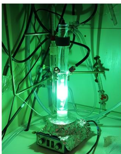
Abbildung 2.3: Paternò-Büchi-Reaktion ausgehend von 31.8 g Aldehyd 57d : Reaktionsaufbau (links) und Abhängigkeit des Umsatzes von der Bestrahlungszeit (rechts).
