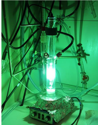
Abbildung 4.2: UV-Batch-Reaktor mit Tauchlampe TQ 150 (150 W Quecksilber-Mitteldruckstrahler) in Betrieb.
