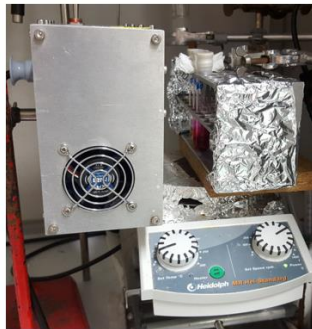
Abbildung 4.7: Bestrahlung mit der grünen oder blauen LED HP (100 W): Links: Aufbau bei Kühlung mit oberhalb platziertem Ventilator (nicht gezeigt). Rechts: Schematische Darstellung der Kühlung mit Hilfe eines wassergefüllten Aquariums.
