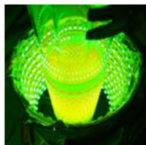
Abbildung 3.11: Umsetzung der photokatalytischen Dehydrierung im Grammaßstab (links) und im kontinuierlichen Flussreaktor (rechts). a Isolierte Ausbeute. b Ausbeute per 1 H-NMR mit 1,4-Bis(trimethylsilyl)benzen als internem Standard.
