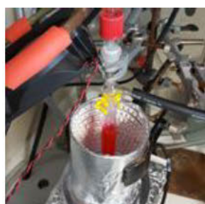
Abbildung 3.11: Umsetzung der photokatalytischen Dehydrierung im Grammaßstab (links) und im kontinuierlichen Flussreaktor (rechts). a Isolierte Ausbeute. b Ausbeute per 1 H-NMR mit 1,4-Bis(trimethylsilyl)benzen als internem Standard.
