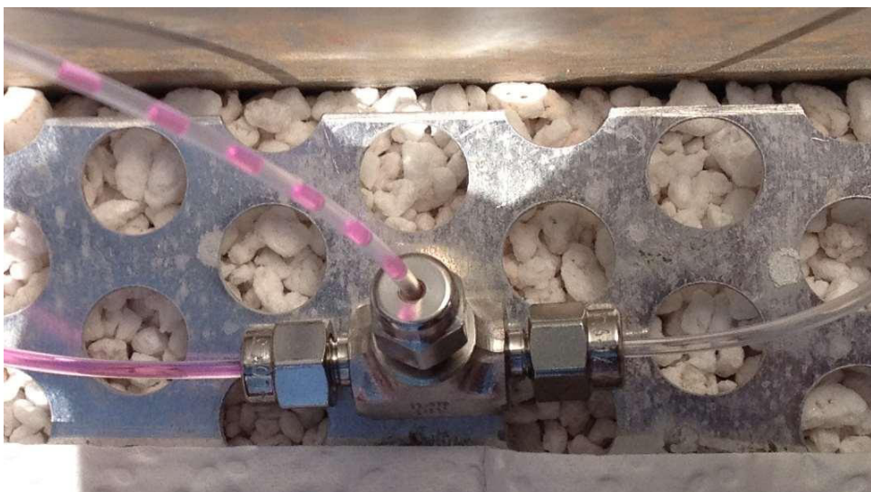
Abbildung 68: Durch ein CTA-Union Tee generierter Taylor-Fluss
