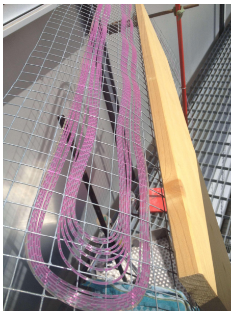
Abbildung 69: Der betriebene „Sunflow“-Reaktor im Taylor-Fluss-Modus. In dem Aufbau sind deutlich die parallel gewebten Kapillaren zu erkennen.
