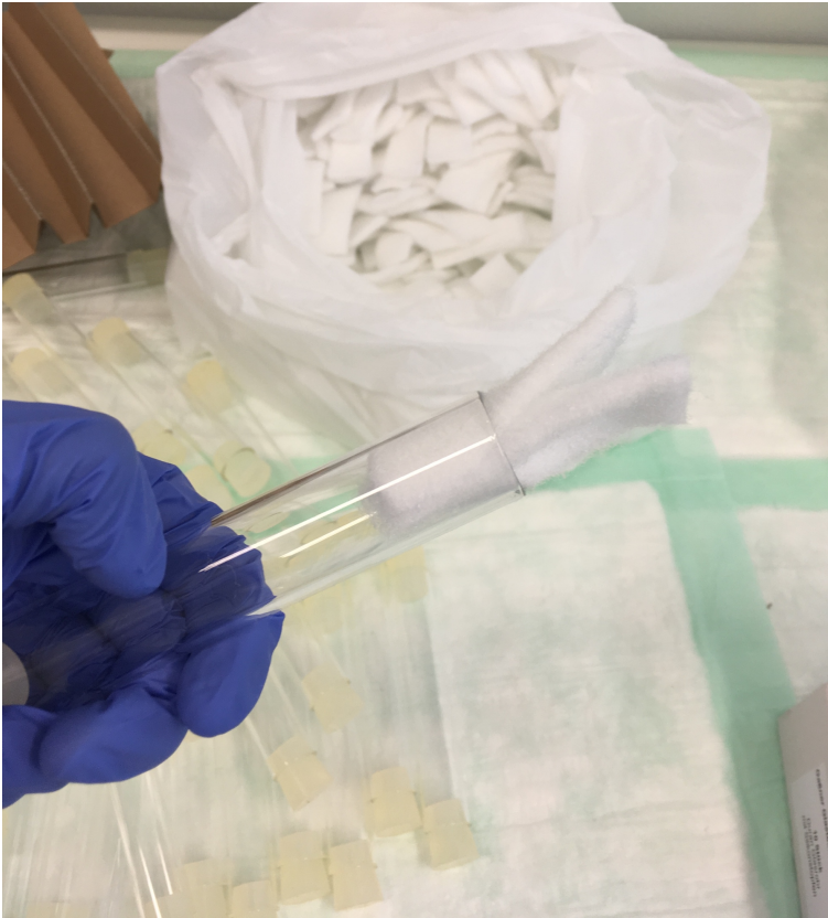
Abbildung 7: Befüllen der Glasröhrchen mit der Polypropylenwatte
