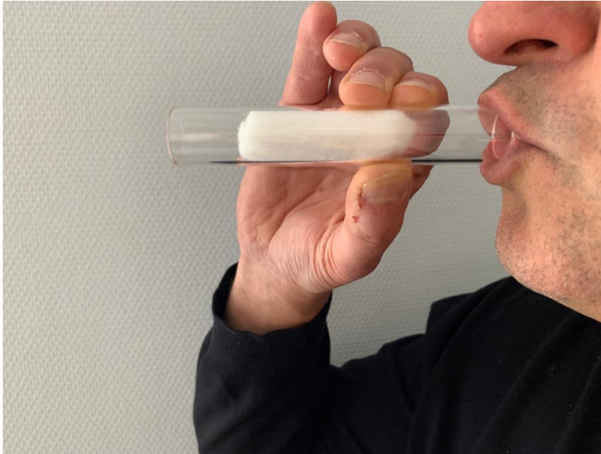
Abbildung 9: Darstellung der Handhabung der Atemproberöhrchen bei der Abgabe der Atemproben
