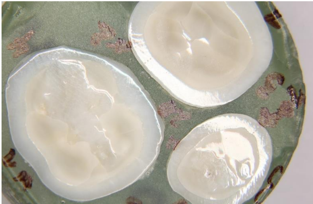
Abbildung 7 Hochglanzpolierte Zahnschnitte, nach Einbetten in Kunststoffkörper und nach Entfernen aller Rückstände
