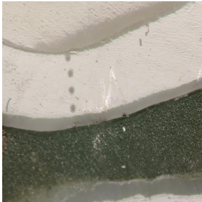
Abbildung 9 Vergrößerung eines Zahnschnitts mit fünf der Messstellen für LA-ICP-MS
