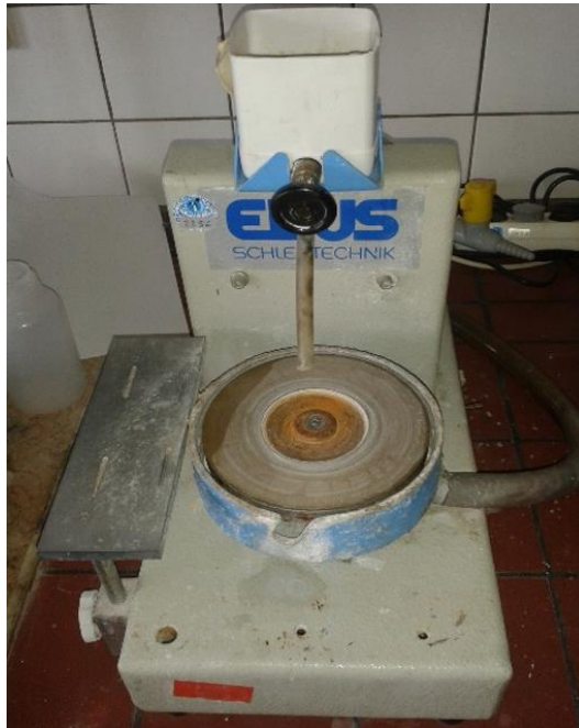
Abbildung 2 Poliervorrichtung mit diamant-ingesinterter Bronzescheibe und Wasserkühlung für den ersten Politurenschritt
