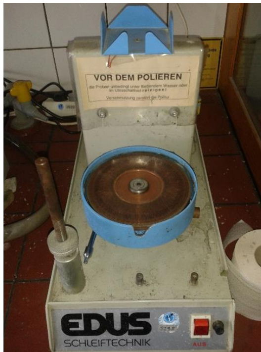
Abbildung 4 Poliervorrichtung zur Hochglanzpolitur
