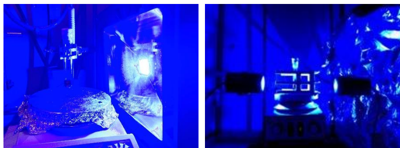
Abbildung 51: Exemplarische Belichtung eines Ansatzes mit dem 100 W LED-Flutlicht (links) und zwei 34 W Breitband LED Spot-Lichtern (rechts).
