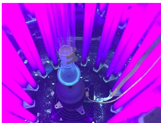
Abbildung 53: Exemplarischer Aufbau für Belichtungen im Rayonet Photoreaktor mit UV-A Lampen.
