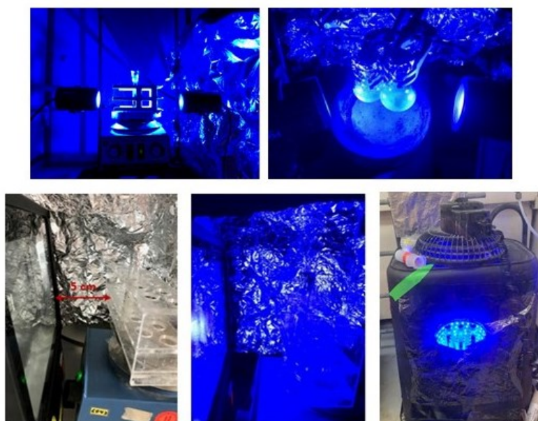
Abbildung 26: Exemplarische Belichtung eines Ansatzes mit zwei 34 W Breitband LED Spot-Lichtern (oben), mit einem 100 W LED-Flutlicht (unten links, Mitte) und mit 12 W LED Streifen (unten rechts).
