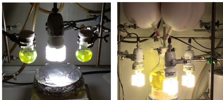
Abbildung 25: Beispielhafte Belichtungen präparativer Photoredoxreaktionen mit einer 25 W UV/Vis-CFL (links) und mit einer 23 W Vis-CFL Haushaltslampe als Multigramm-Maßstabs Ansatz.
