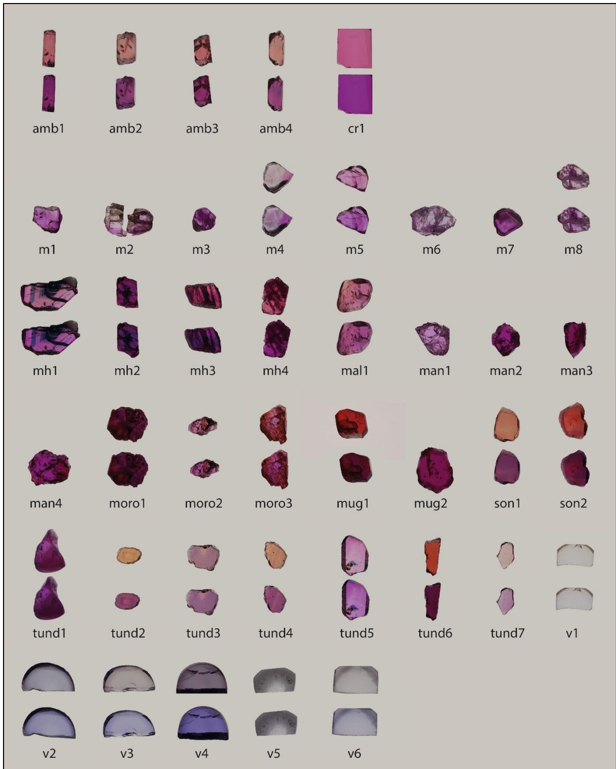
Abbildung 8: Makroskopische Aufnahmen aller verwendeten Korundproben. Die Fotos wurden unter Verwendung eines Polarisationsfilters aufgenommen. Die obere Reihe repräsentiert die Farbe des Absorptionsspektrums E parallel c , die untere Reihe die Farbe E senkrecht c . Die Fotos sind in Transmission (D65) aufgenommen. Zu beachten ist, dass die Proben nicht im maßstabsgetreuen Größenverhältnis zueinander dargestellt sind. Zudem stellt die Farbe E parallel c oftmals eine Mischfarbe dar, repräsentiert das Spektrum E parallel c also nur bei exakter Orientierung. Wurde bei einer Probe kein Pleochroismus beobachtet, so ist nur die Farbe E senkrecht c gezeigt.
