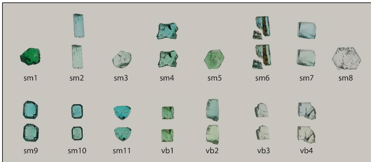
Abbildung 9: Makroskopische Aufnahmen aller verwendeten Beryllproben. Die Fotos wurden unter Verwendung eines Polarisationsfilters aufgenommen. Die obere Reihe repräsentiert die Farbe des Absorptionsspektrums E parallel c , die untere Reihe die Farbe E senkrecht c . Die Fotos sind in Transmission (D65) aufgenommen. Zu beachten ist, dass die Proben nicht im maßstabsgetreuen Größenverhältnis zueinander dargestellt sind. Zudem stellt die Farbe E parallel c oftmals eine Mischfarbe dar, repräsentiert das Spektrum E parallel c also nur bei exakter Orientierung. Wurde bei einer Probe kein Pleochroismus beobachtet, so ist nur die Farbe E senkrecht c gezeigt.
